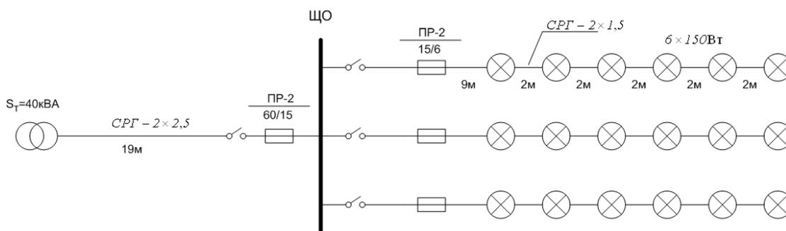
Рисунок 1 – Исходная схема осветительной сети.
